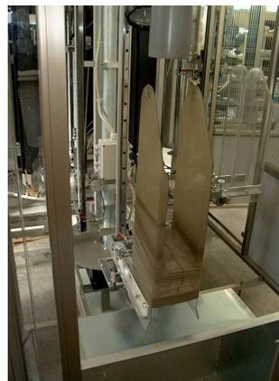
Gruppo Caricatore Automatico per un miglior controllo e facilità di carico. (BREVETTATO)
