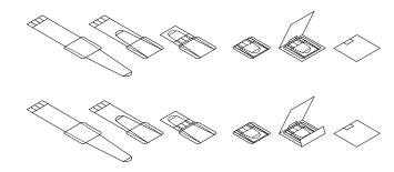
SEQUENZA PIEGHE PER MACCHINA IM3/ FOLDING SEQUENCE FOR MACHINE IM3
